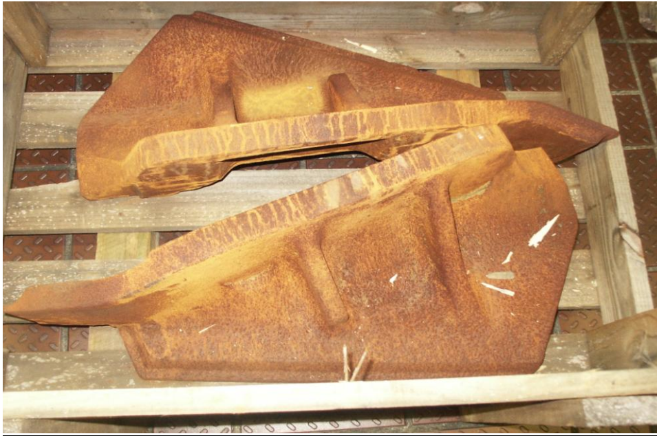
Abb. 1 a: GS16MN5N-Formteile vor der Entrostung
