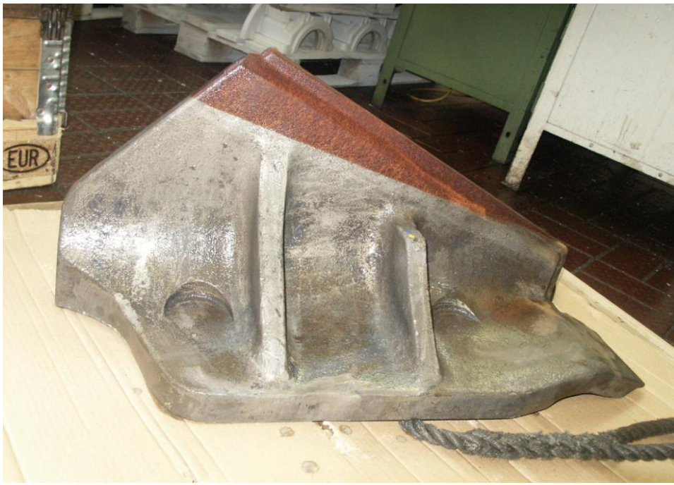
Abb. 1 b: GS16MN5N-Formteile nach der Entrostung
