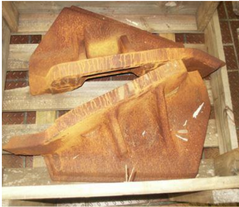
Abb. 1: GS16MN5N-Formteile vor der Entrostung
