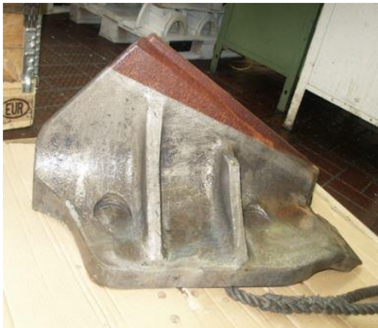
Abb. 2: GS16MN5N-Formteile nach 60 min biotechnischer Entrostung
